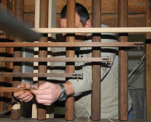
Alain Vandewyer plaatst de registermechaniek onder in het orgel. De horizontale registerstangen bewegen als de organist een registerknop opentrekt. De verticale stangen draaien rond hun as, en openen boven de registerslepen in de windlade.
