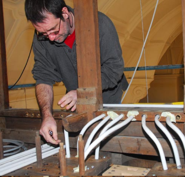
Marc Van den Bulck past de loden conducten in die de wind moet geleiden naar de frontpijpen. De conducten zijn hier nog met krijtlijm geveerd om ze beter te kunnen solderen.
