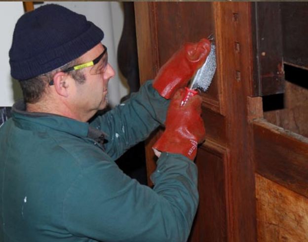
Willy Leys verwijderd de oude verflagen van de rugwand van het Colinorgel.
